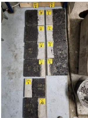
Figur 25. Ett set av 10 plattor med olika fogvarianter tillverkade för 3-punktsskjuvtest. Foto: Patryk Witkiewicz.
