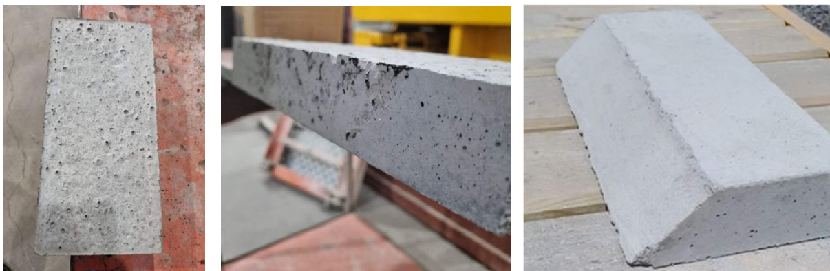
Figur 16. Betongplattor avlägsnade från träformar (0° och 45°). Foto: Patryk Witkiewicz, Ehsan Ghafoori.
