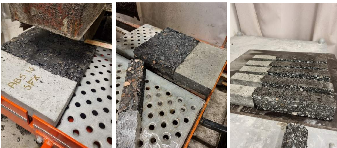
Figur 26. Exempel på sågning av plattor till balk-prover med dimensioner 50x50x350 mm. Foto: Patryk Witkiewicz.
