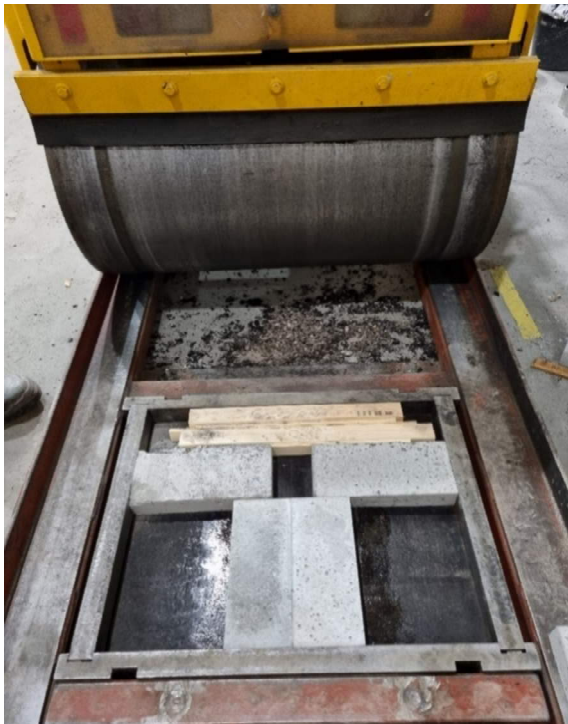
Figur 19. Exempel på placering av betongplattor före produktion av fogar. Foto: Patryk Witkiewicz.
