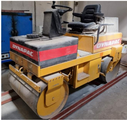
Figur 18. Vält på en räls som användes för packning av plattor. Foto: Patryk Witkiewicz.
