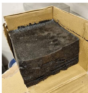
Figur 12. Fogtätningssmassa i en klump. Foto: Patryk Witkiewicz.
