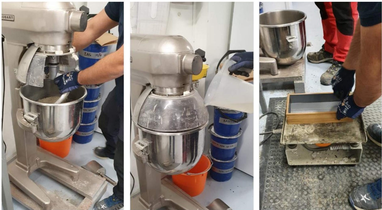
Figur 15. Process av betongblandning. Foto: Patryk Witkiewicz, Ehsan Ghafoori.
