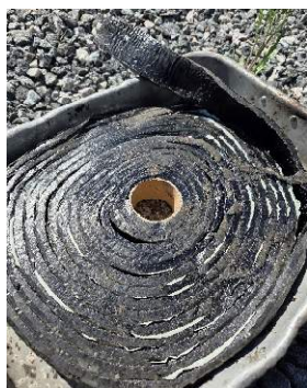
Figur 11. Fogband med dimensioner på 40 x 10 mm. Foto: Patryk Witkiewicz
